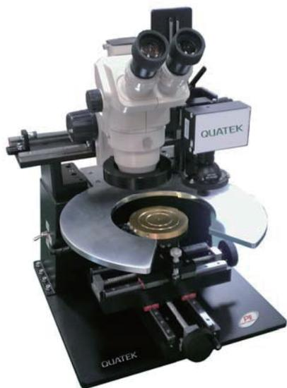
PG101WIS是整合手動探針台以及光譜儀系統用於分析光學材料之設備,其應用於LED, PD, Vcsel, Laser diode等。
